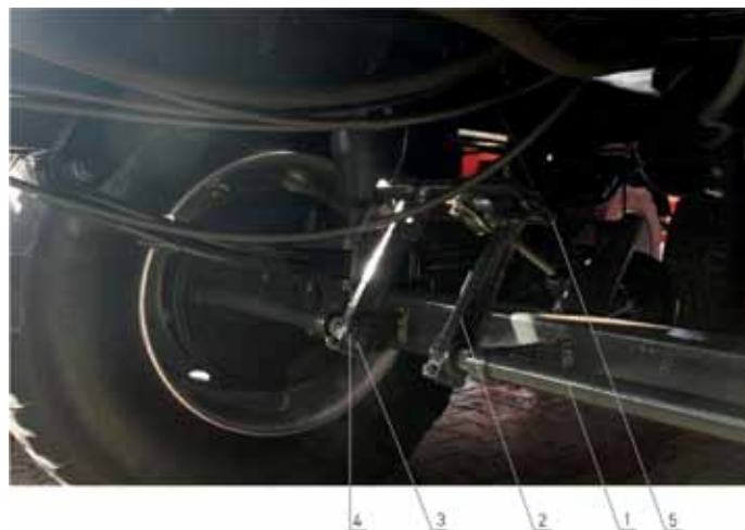
Рис. 6. Элементы тормозной системы: 1-вал тормозного кулака, 2-рычаг (плечо) вала тормозного кулака, 3- регулирующий „гребень” на вале тормозного кулака, 4- гайка, регулирующая положение рычага на вале, 5- тяга (толкатель), соединяющая поршень пневмоцилиндра с плечом вала тормозного кулака.
