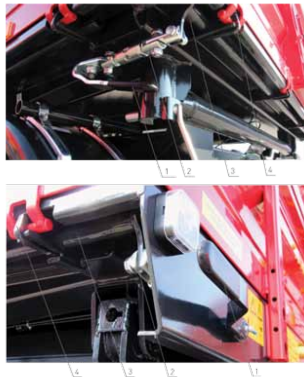
Рис. 5. Запоры бортов грузового кузова 1 - центральный рычаг нижних замков, 2 – механизм регулировки замков, 3 - центральный вал замков, 4 - замок
