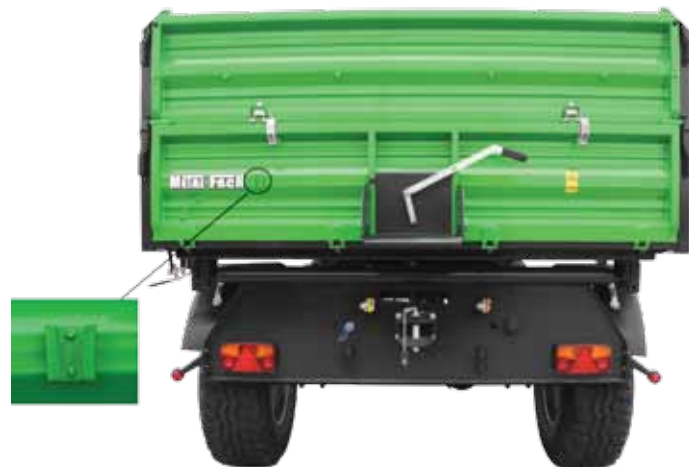
Рис. 4. Размещение опознавательного знака тихоходных транспортных средств
