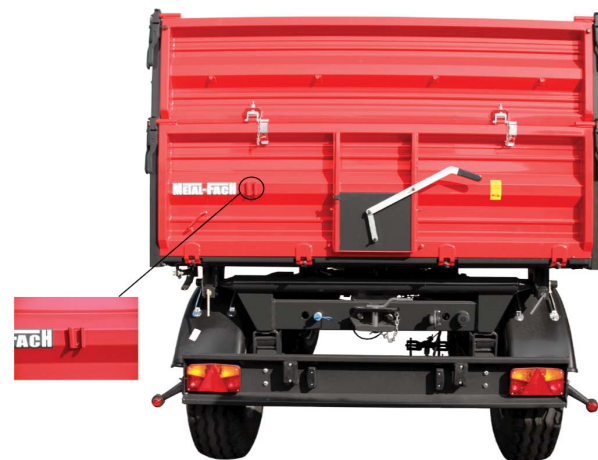
Рис. 4. Размещение опознавательного знака тихоходных транспортных средств
