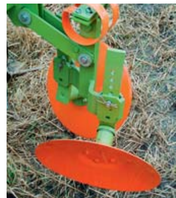
Пружинный механизм защиты дисков
