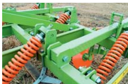
Пружинный механизм защиты рыхлящих лап
