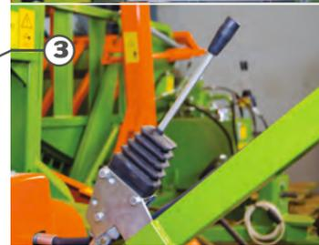
Дистанционная система управления позволяет управлять пресс-подборщиком из кабины трактора.
