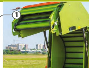
Камера постоянного объема, формирует высокоплотные рулоны идеальной цилиндрической формы. Имеет увеличенное количество прессующих валов, изготовляемых из высоколегированной стали: валы и цепи обеспечивают прессование травяной массы повышенной влажности.
