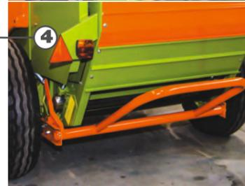
Выталкиватель рулонов оптимизирует рабочее время, облегчает и ускоряет разгрузку рулонов.
