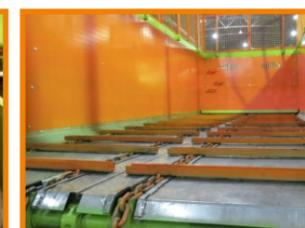
Двухдорожный транспортер из круглозвенной высокопрочной цепи значительно снижает трудозатраты при наладке и техобслуживании;
