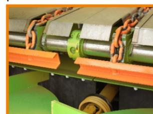
Днище прицепа из нержавеющей стали значительно продлевает срок службы и повышает износостойкость;
