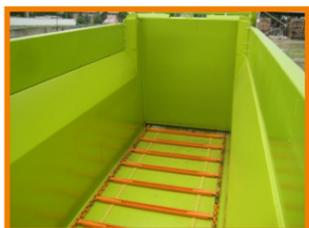
Однодорожный транспортер выполнен из круглозвенной высокопрочной цепи для снижения трудозатрат при наладке;
