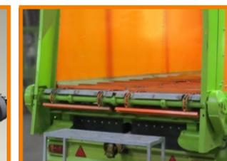
Сдвоенный привод выгрузного транспортера повышает надежность работы при перегрузках;
