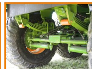
Гидравлическое блокирующее устройство управляемых осей обеспечивает устойчивое движение по дорогам общего пользования;
