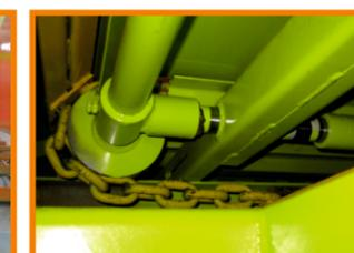
Гидравлический натяжитель цепей выгрузного транспортера обеспечивает простоту и скорость обслуживания;
