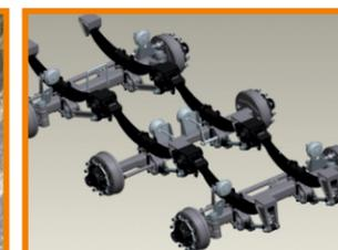
Балансирная подвеска осей с параболическими рессорами равномерно распределяет нагрузку на все колеса и снижает динамические нагрузки на трактор;
