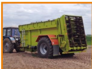
Шины больших размеров препятствуют чрезмерной утапковке и повреждению почвы;
