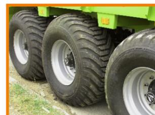
Управляемые усиленные оси (ADR) с шарниром на 9° обеспечивают высокую устойчивость и повышают маневренность;
