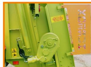
Изменяема скорость транспортера до 2,5-3 м/мин, что позволяет изменять дозу внесения удобрений
