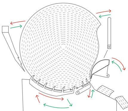
Дополнительный съемный лоток позволяет использовать резик рулона в хозяйствах, где установлены высокие кормушки.
