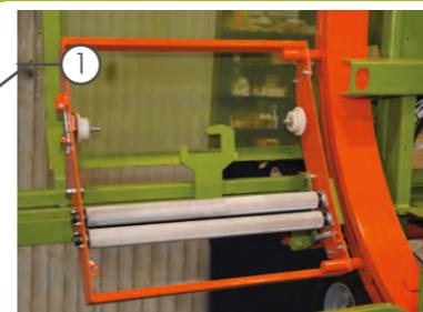
Каретка снабжена натяжным устройством для плотной обмотки рулонов.
