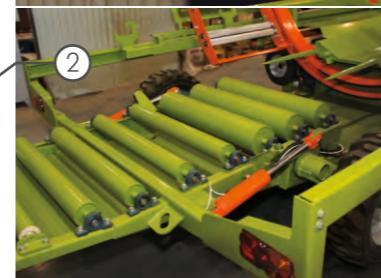
Наклонный механизм позволяет быстро переключать упаковщик в транспортное положение и обратно.
