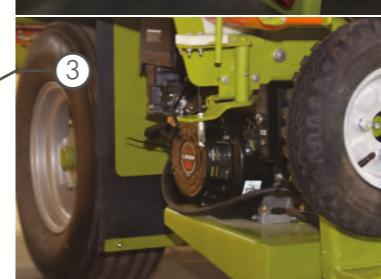
Двигатель внутреннего сгорания с электрическим стартером обеспечивают автономную работу упаковщика.
